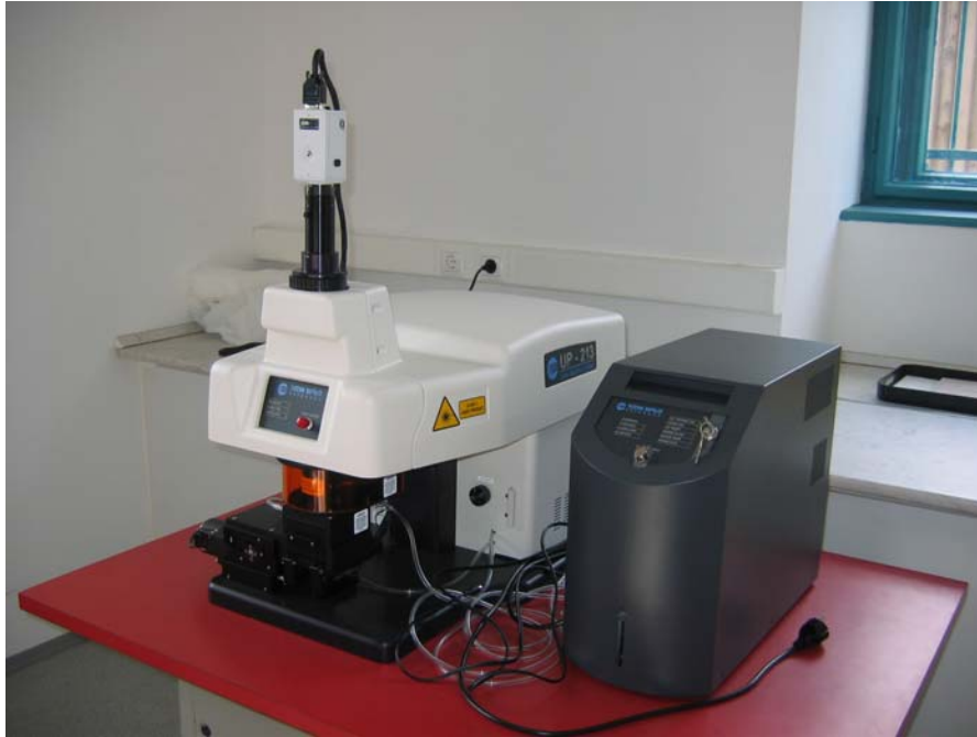
New Wave UP 213 lézer ablációs egység. A Perkin Elmer ELAN DRC II ICP-MS készülékkel csatolva szilárd minták, főleg csiszolatok nyomelem-tartalmainak közvetlen, feltárás nélküli meghatározására szolgál, lokális és zonációs vizsgálatok is végezhetők.
