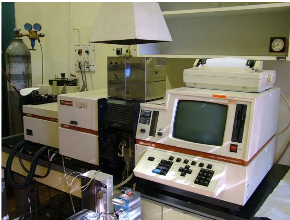
Varian SpectrAA 10BQ atomabszorpciós spektrométer. El van látva láng; grafitkemencés és hidridtechnikájú feltéttel is. (A képen a hidridfejlesztéses feltét látható.)
