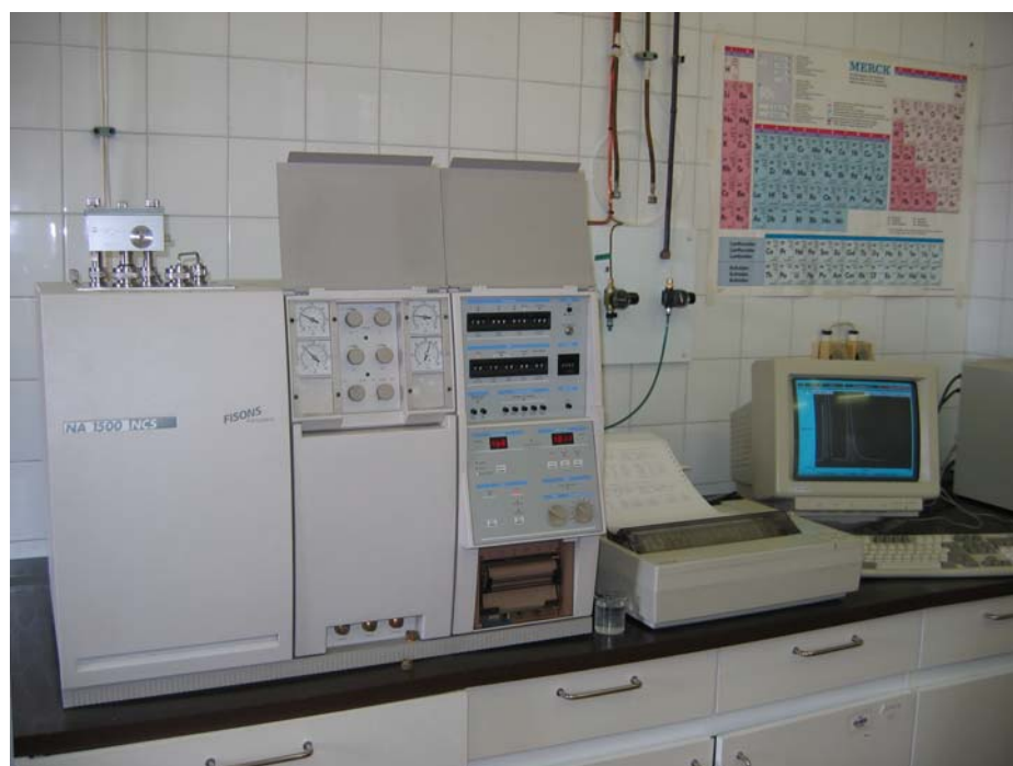
FISONS Carlo Erba NA 1500 NCS elemanalizátor, amellyel kőzetminták szén-, kén-hidrogén és nitrogéntartalmát határozzuk meg, főleg szervesgeokémiai értékelések céljaira.
