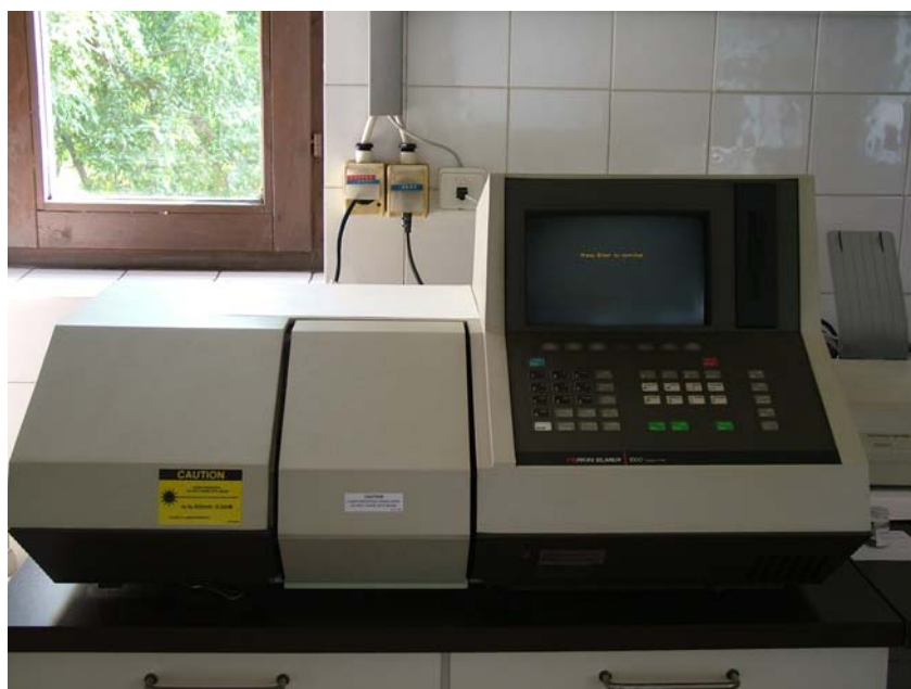
Perkin Elmer 1600 FTIR Fourier transzformációs infravörös spektrofotométer
