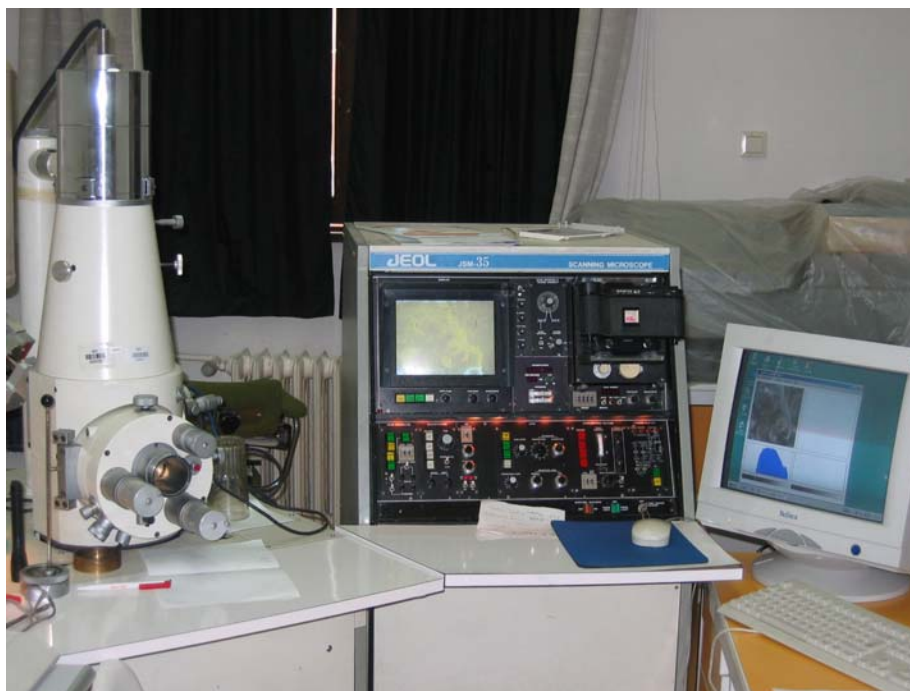
JEOL JSM 35 pásztázó elektronmikroszkóp EDAX feltéttel 200-20 000-szeres nagyítás, ásványtani és mikropaleontológiai vizsgálatokhoz.
