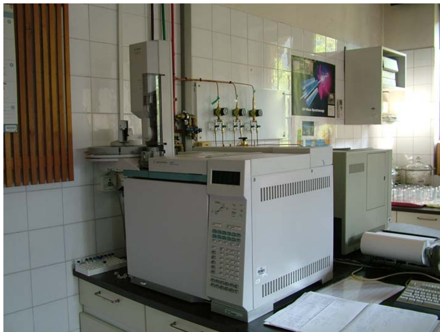
Agilent 6890N gázkromatográf lángionizációs és elektronbefogós detektorral, valamint DANÍ headspace analízátorral ellátva.
