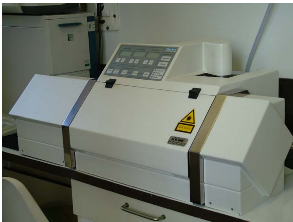
Fritsch Analysette 22 E lézeres szemcseelemző berendezés részecskeméret-analízishez.
