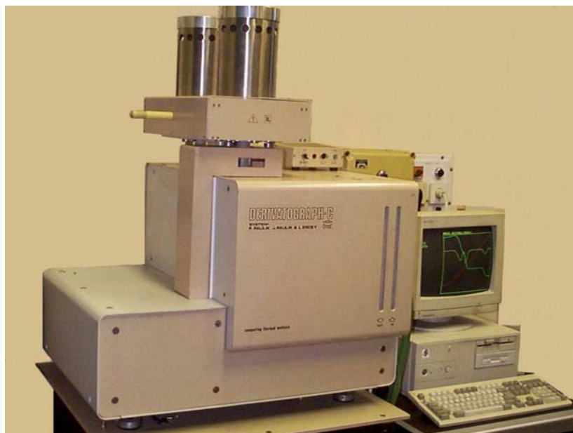
MOM Derivatograph PC termoanalitikai berendezés, vezérlő és kiértékelő szoftverrel
